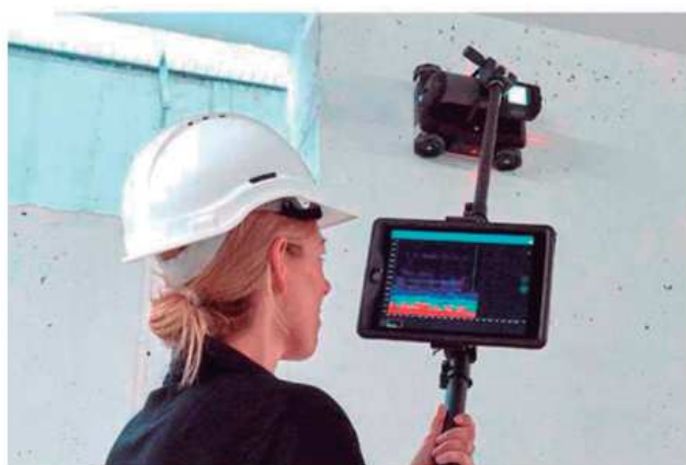
Proceq GPR Live combinado com a haste telescópica com suporte para tablet
