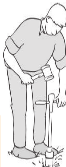
O suporte com o anel amostrador é então introduzido no solo por percussão com o martelo anti-repique.
