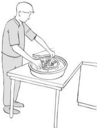
A placa cerâmica e as amostras de solos são completamente saturadas com água.
