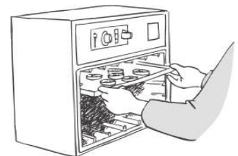
No fim do processo, as amostras são pesadas e secadas em estufa, para determinação do teor de umidade.
