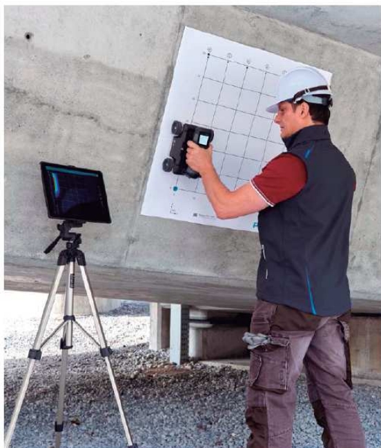
Proceq GPR Live fazendo a varredura de uma área com a ajuda de papel quadriculado Proceq
