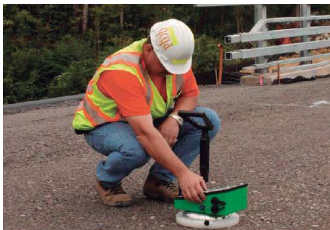
4.100.030 - Medidor de Densidade de Solo - Não nuclear - (norma ASTM D7830)
